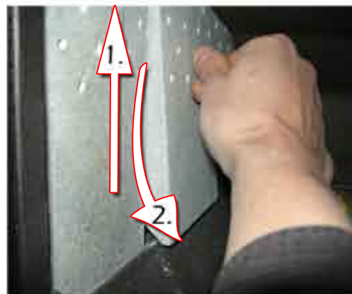
3. Lyft stenen uppåt ca 5-7 mm med hjälp av skruvmejseln. Släpp sedan ned stenen något och vinkla in nederkanten in mot eldstaden och släpp sedan ned den hel & hållet.
